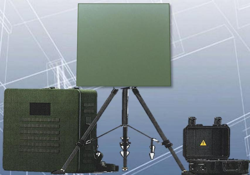
Предназначена для работы в сетях спутниковой связи VSAT через геостационарные космические аппараты «Ямал» и «Экспресс» в Ku-диапазоне частот по схеме организации связи «звезда»
